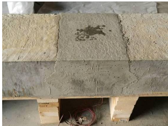
Closure pour concrete cast.
