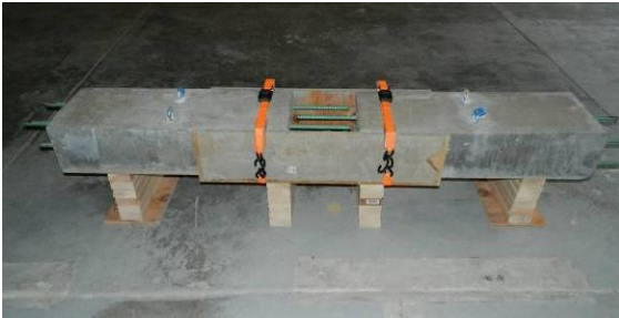
Closure pour concrete formwork.
