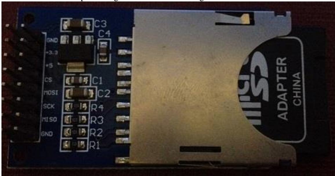
Fig.16 SD card module
